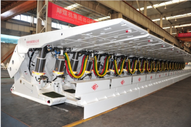
Komplet samohodnih hidrauličnih podgrada isporučenih u rudnik Oak Grove Mine, SAD, 66.000 ciklusa testiranih po Konzolnom standardu, Prvi kpl. širokočelnih podgrada iz Kine u radu u SAD
