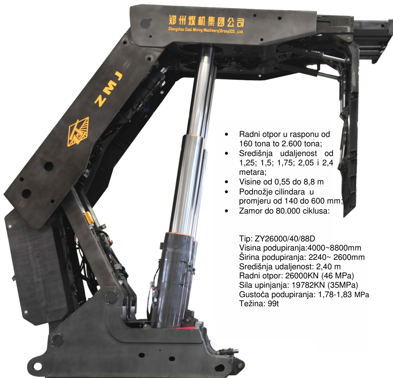
Samohodna hidraulična podgrada visine 8,8 m za Grupu Shenhua, Kina
