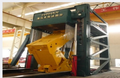
Automatizirano testiranje životnog vijeka 30000kN/3000T. Testno postrojenje nalazi se u Zhengzhou
