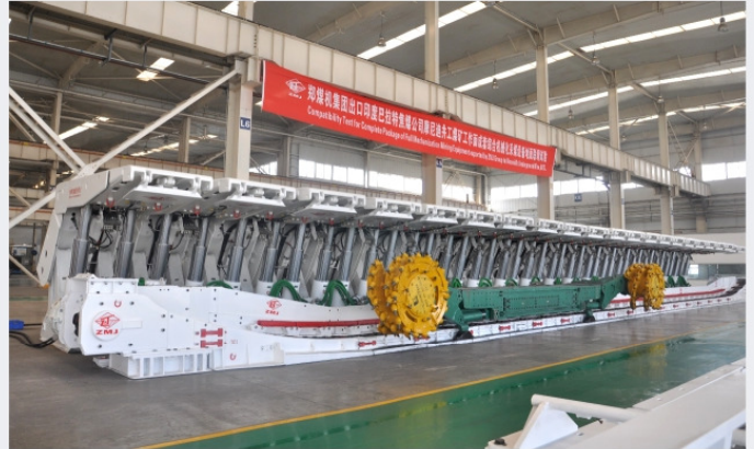
Komplet širokočelnog sistema isporučen u rudnik Moonidih, Indija. Isporučen na temelju "ključ u ruke" uklj. instalaciju, stavljanje u pogon & rad.
